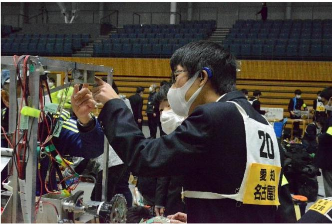
プレイヤーロボットのフライングディスクを保持するアーム機構部を確認している様子
